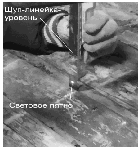
Рисунок 3 – Демонстрация момента фиксации положения измеряемой точки поверхности яла на линейке щупа по световому пятну лазерного дальномера
